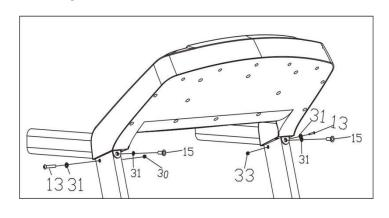
Для выполнения данного шага вам снова потребуется помощь второго человека. Выполните соединение проводов, после чего установите консольную конструкцию на стойки тренажёра. Закрепите консоль при помощи болтов (13 и 15) и шайб (31). Для того, чтобы затянуть крепёж, воспользуйтесь шестигранником (83).
