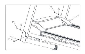
Поднимите верхнюю часть беговой дорожки, зафиксируйте конструкцию при помощи болтов (12 и 15) и шайб (31). Затяните крепёж при помощи шестигранника (83).
