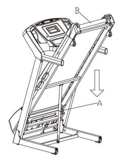
Для того, чтобы разложить тренажёр, немного надавите ногой на пневматическую пружину (A), держась при этом за край беговой платформы (B). Продолжая давить на пружину, начните опускать беговую платформу вниз. Затем уберите ногу и отпустите платформу – тренажёр автоматически примет рабочее положение.
